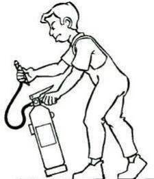
2. Asir la boquilla de la manguera del extintor y comprobar, en caso que exista, que la válvula o disco de seguridad (V) está en posición sin riesgo para el usuario. Sacar el pasador de seguridad tirando de su anilla.
