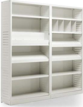
Estantería metálica modelo EMSA de dimensiones 1000x400x2000mm. Estantería con 4 bastidores metálicos con unión en laterales con refuerzo. Cada cuerpo contará con cinco estantes metálicos regulables en altura sin tortillería. Cruz de arriostramiento en extremo de cada bloque formado a base de cuerpos.
